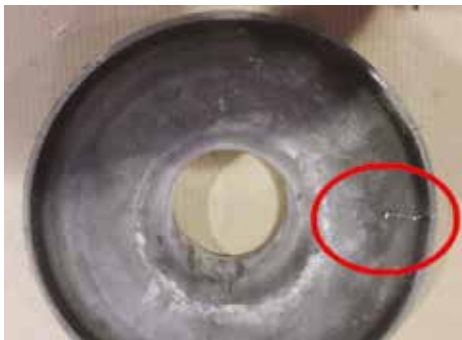
T-Plate nach mehreren Gießzyklen, mit ersten Rissen (Foto AWW, IKGB)
