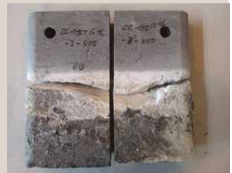
CC 155 G16, ohne Zusatz, gefräst Einsatzdauer 48 Stunden
