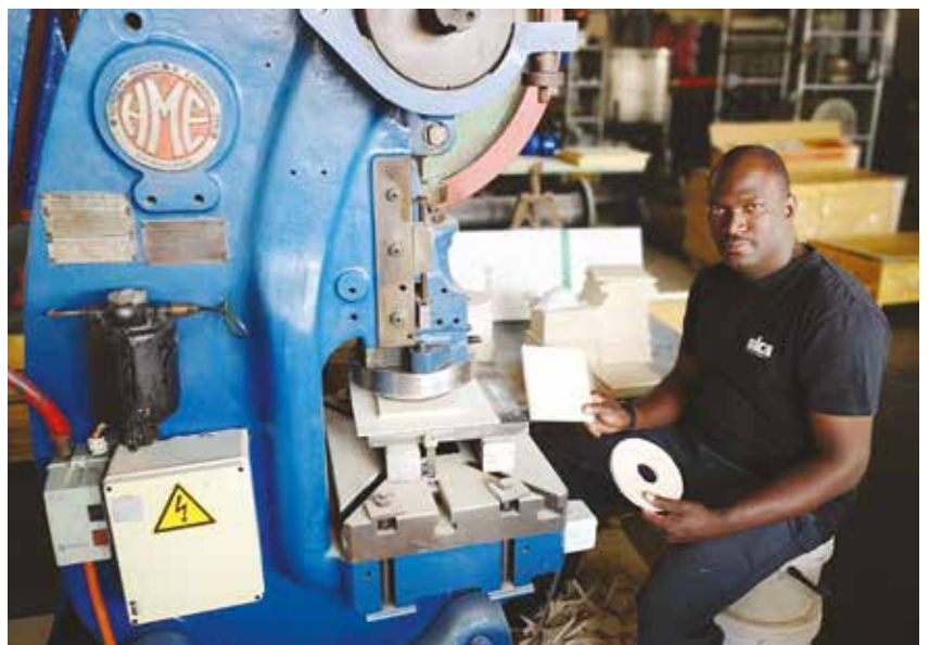
Unsere 45 Tonnen Kurbelwellenpresse. Mit dieser können wir Dichtungen von bis zu 400 mm Durchmesser bei einer Dicke von 30 mm schneiden. Das Plattenmaterial kommt von SILCA Mettmann (hier Silcasal 110-96B). Anwendung findet diese Dichtung im Niederdruckgussverfahren.
