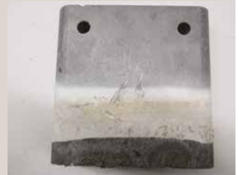
CC 155 G16, Zusatz BN-G, geschliffen Einsatzdauer 60 Stunden
