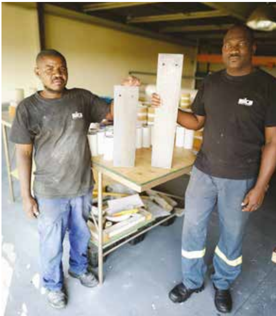
Sogenannte „baffle plates“ welche wir aus Fused SILCA gießen. Sie finden ihre Anwendung beim Entgasungsprozess von flüssigem Aluminium in rotary degassing machines.
