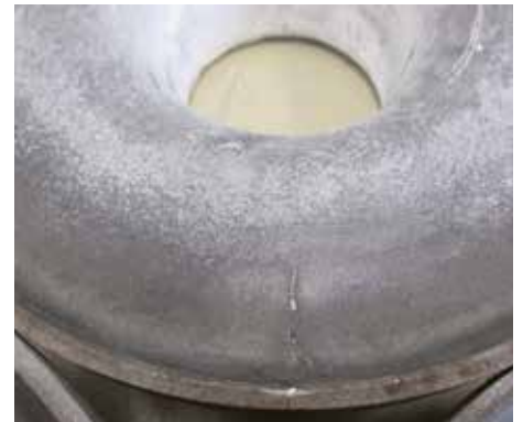
Bild 4: T-Plate, gerissen (AWW) (Quelle: AWW)
